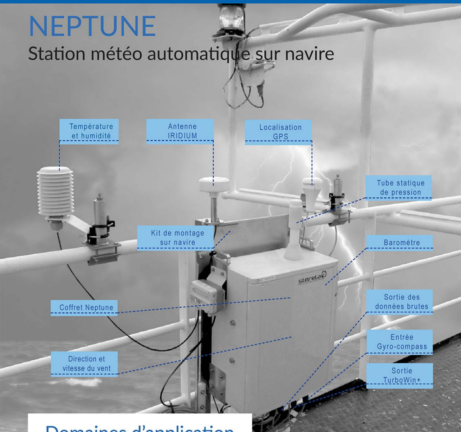
Sterela propose une station météo automatique embarquée sur navire conçue pour l'acquisition et la transmission de données en environnement sévère.
